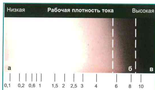
Рис. 1. Вид пластинки, полученной при анализе на ячейке Хулла: а) блестящая (полублестящая) зона — влияние структурообразующих (блескообразующих) добавок; б) зона матовости — влияние подавляющих добавок; в) подгар — влияние концентрации меди в электролите (диффузионное ограничение по ионам меди)
