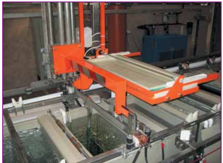
Рис. 2. Система каплеулавливания предотвращает загрязнение растворов при перемещении автооператора
